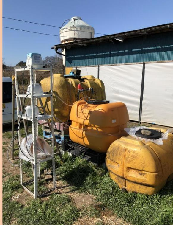
「バイオ液肥プラント」は「BOリアクター」を家畜し尿槽内に吊るし曝気することで、し尿成分を分解して、バイオ液肥として再資源化することができます。
